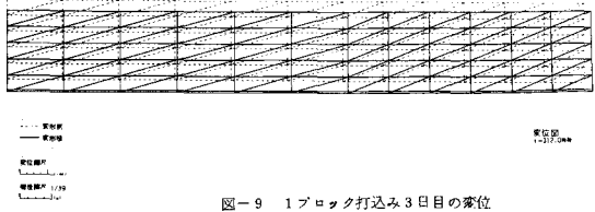
図-9 1ブロック打込み3日目の変位
