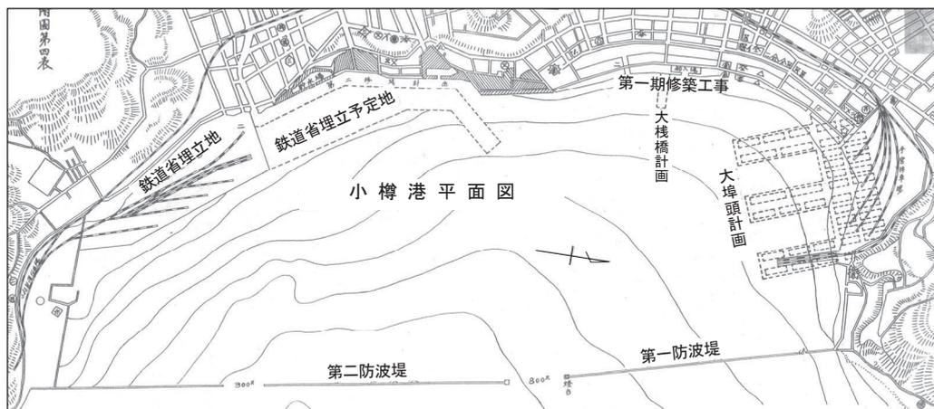
図-6 小樽港修築計画平面図
