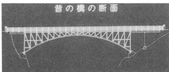
図一8 渡良瀬橋鉄アーチ橋骨格図<sup>11)</sup>
