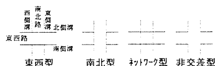
図9 街路交差部での溝の接続法
