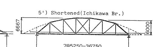
図4 ポーストリングトラスのスケルトン（番号は表1のものと対応させてある）。
