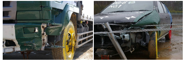
写真-15 衝突車両の破損状況（左：大型車、右：乗用車）
