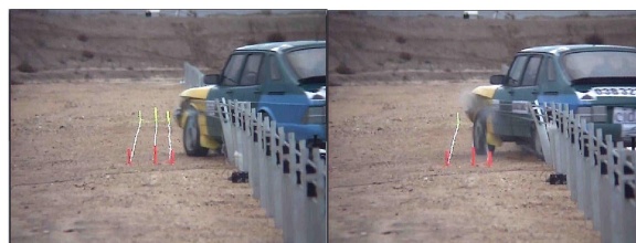
写真-4 ワイヤーロープ式防護柵の衝突実験状況 5)
