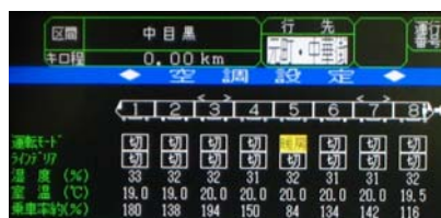
写真-1 運転席モニターに表示される乗車率
