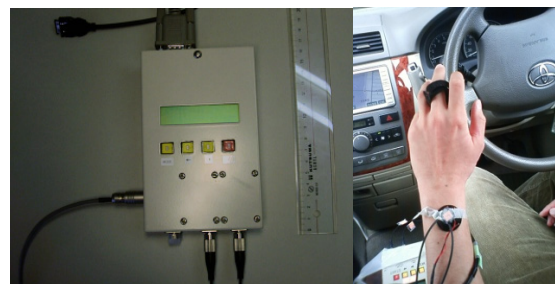
図 4 バイタルセンサ(左図)とプローブ装着状況(右図)
