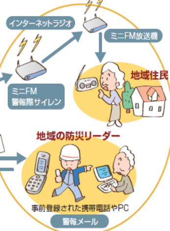
図-2 地域水害情報収集・警報発令システムの概要
