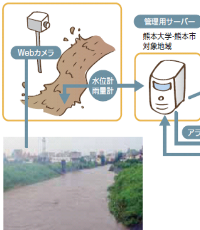
図-2 地域水害情報収集・警報発令システムの概要
