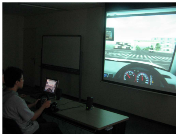
図-1 簡易 DS を用いた運転状況
