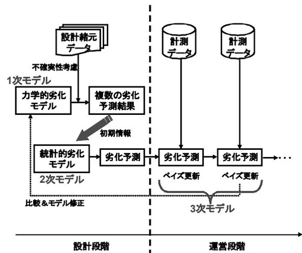
図-1 ハイブリッド劣化モデルの特性
