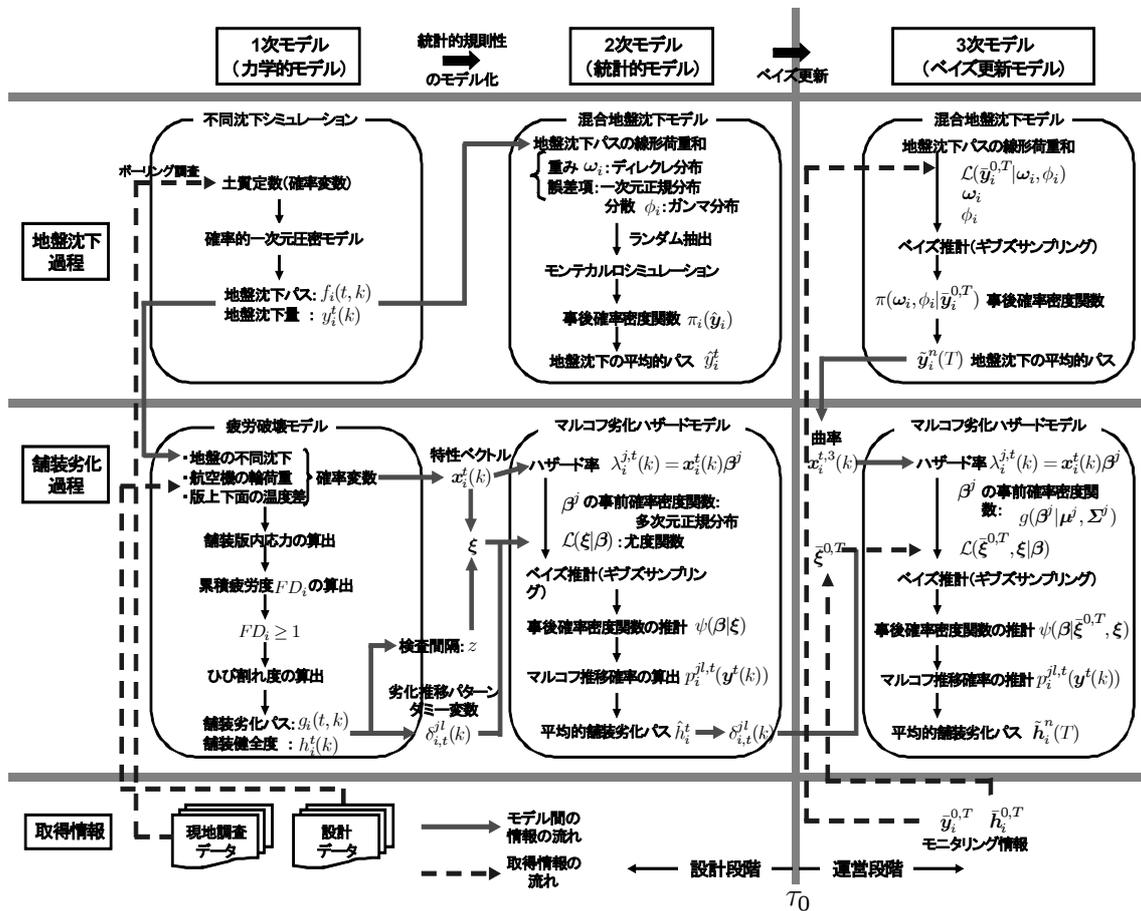
図-2 ハイブリッド劣化モデルの構造
