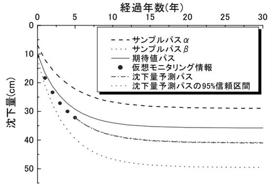
図-8 地盤沈下量のモニタリング情報
