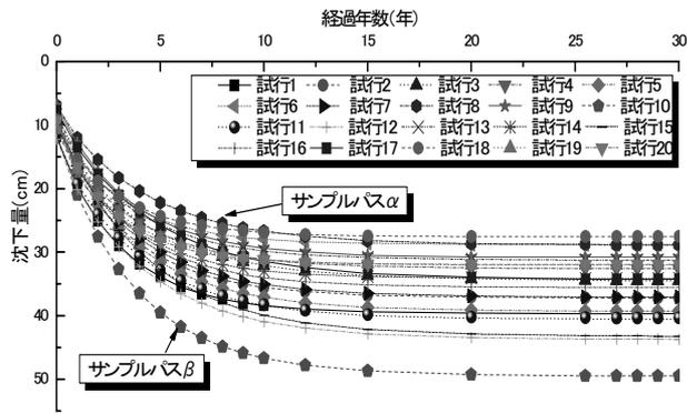
図-4 地盤沈下パス ( $i = 73$ )
