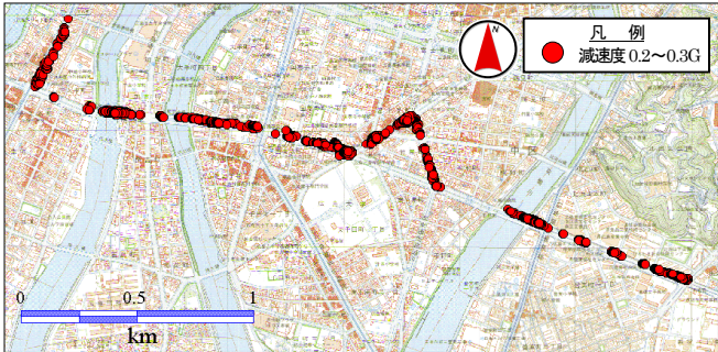
図5 減速行動の発生状況(上り: 0.2G \leq \text{減速度 } \alpha < 0.3G )
