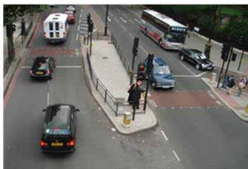
図-2 クランク型横断歩道構造(ロンドン市)
