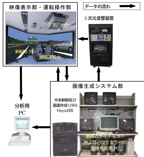
図-11 ドライビング・シミュレータの構成
