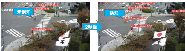
図-10 AI の未検知により軌跡が途切れている事例
