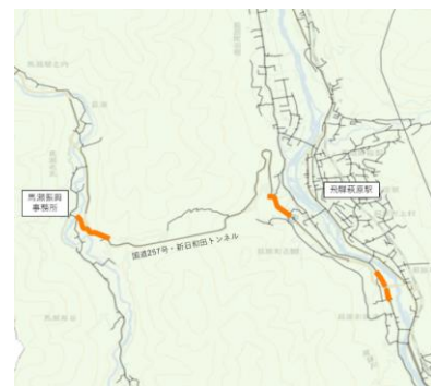
図-13 馬瀬と萩原を結ぶ配電線の様子
