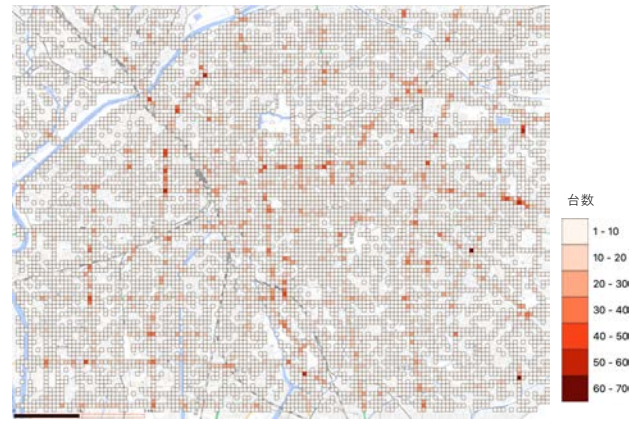
図-4 航空写真により観測された車両のメッシュごとの台数
