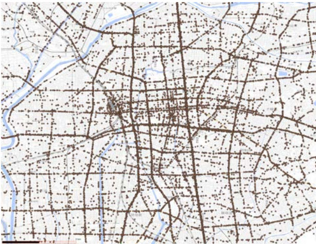
図-3 ETC2.0により特定されたすべての車両位置（すべての対象日と時刻の結果の重ね合わせ）
