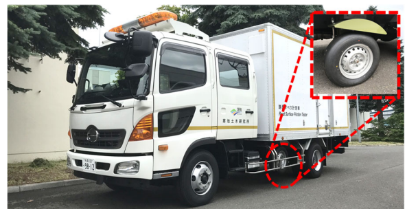
図-3 路面すべり摩擦係数計測装置
