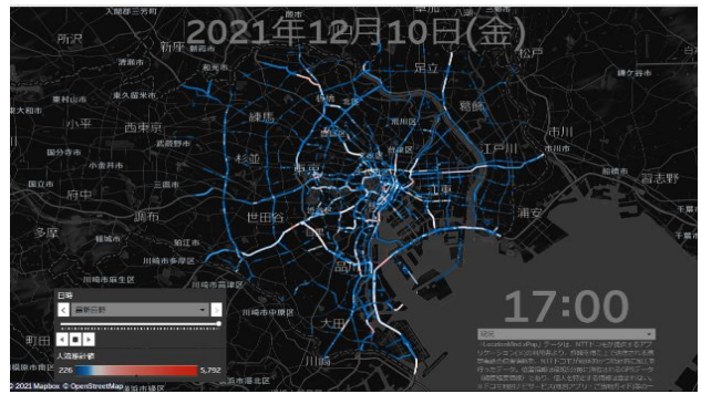
図-5 東京 23 区周辺の道路リンク上のリアルタイム人流の可視化
