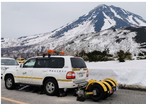
図-6 連続すべり摩擦抵抗測定装置
