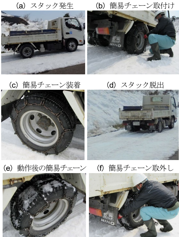
図-10 金属チェーン1回目の実験状況
