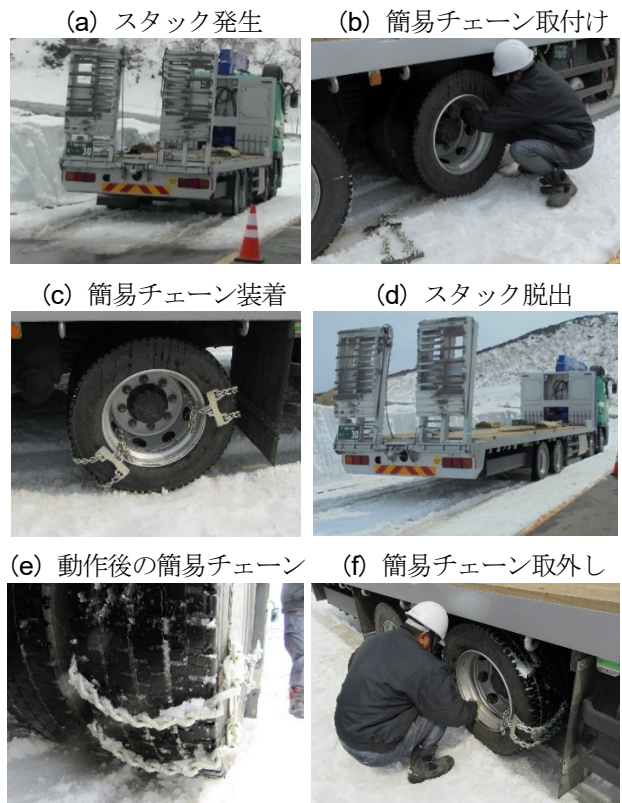
図-13 緊急脱出用チェーンの実験状況
