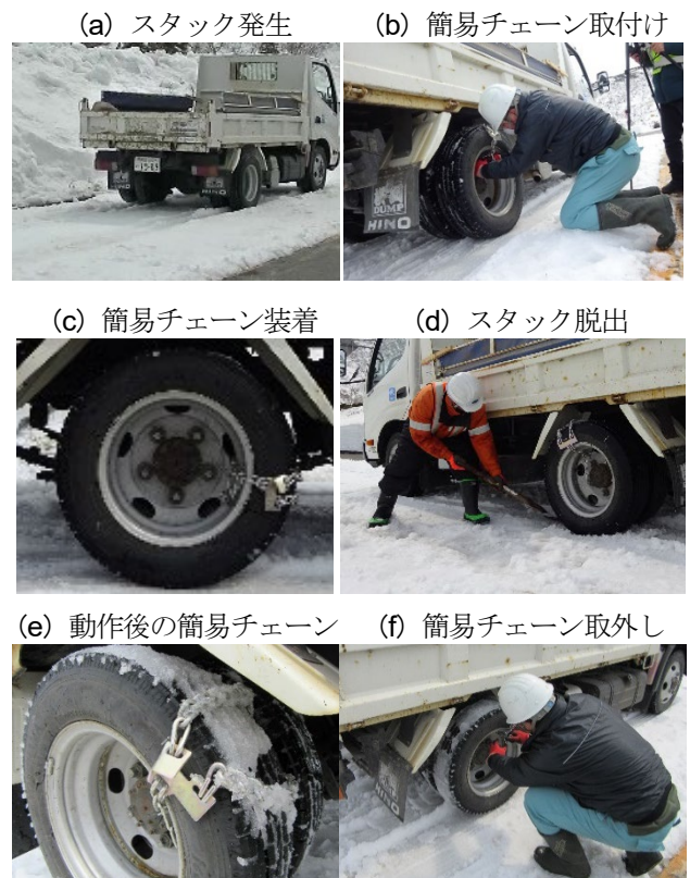
図-9 緊急脱出用チェーン2回目の実験状況
