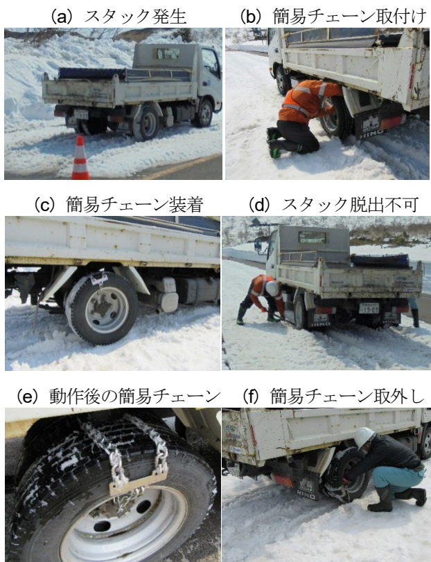
図-8 緊急脱出用チェーン1回目の実験状況
