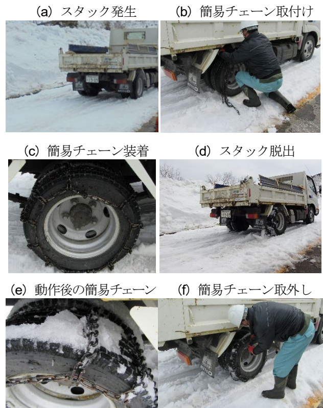
図-11 金属チェーン2回目の実験状況
