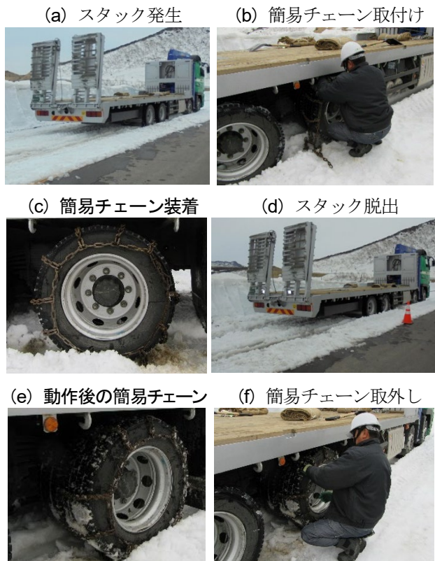
図-14 金属チェーン2回目の実験状況
