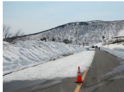
図-4 実験路（圧雪路面）の製作
