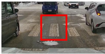
(b)シャーベット路面 すべり摩擦係数計測値 : 0.355
