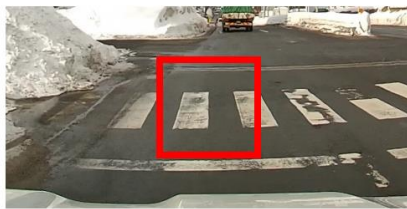
(a)非積雪路面 すべり摩擦係数計測値 : 0.653
