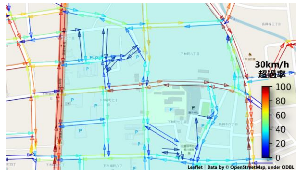
図-11 30km/hを超える走行の割合とゾーン30区間
