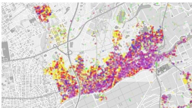
図-7 益城町の住家の被害認定調査結果 紫-全壊，青-大規模半壊，赤-半壊，黄色-一部損壊，緑-被害なし
