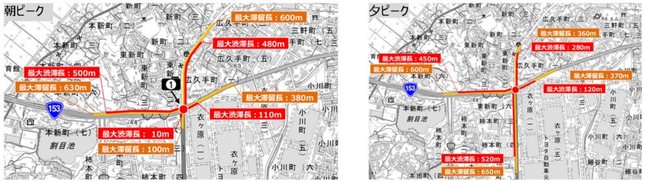
図-9 流入方向別最大滞留長と最大波滞長（東新町2交差点 左：朝ピーク時 右：夕ピーク時）
