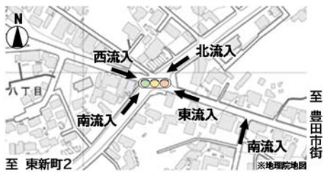
図-36 需要交通量算出方向（宮上町8交差点）
