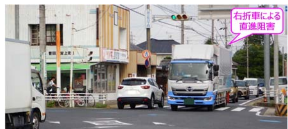
図-18 右折ブロックの様子 (宮上町 8 交差点 朝ピーク時)
