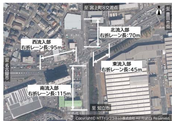
図-2 東新町 2 交差点の道路形状と右折車線長
