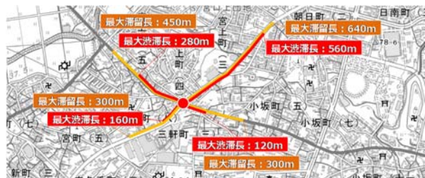
図-17 流入方向別最大滞留長と最大渋滞長 (宮上町 8 交差点 朝ピーク時)
