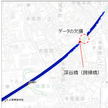
図 11 跨線橋による遮蔽と想定されるデータ欠損
