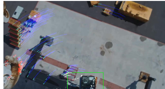
図-6 セット 2 の分類結果。 青は静止物体, 赤はフック, 白は操縦室を表し 緑色の矩形は今回設定した操縦室領域を指す。
