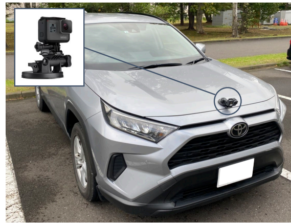
図-1 本技術におけるカメラ設置状況
