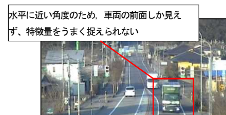
図-8 車種別精度が低い箇所の一例（設置高さ 8m）
