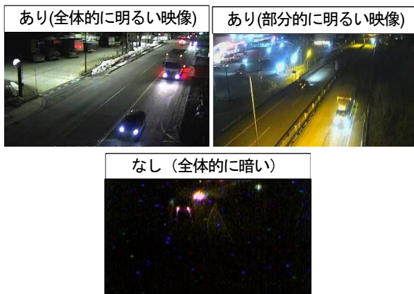
図-10 照明設置状況別の映像一例
