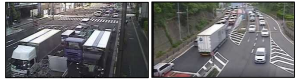
図-3 オクルージョンによる精度低下の一例
