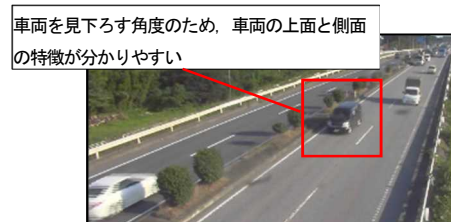
図-7 車種別精度が高い箇所の一例（設置高さ 8m）
