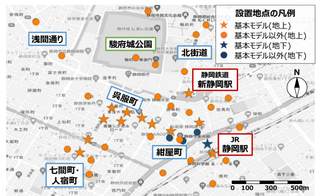
図-3 Wi-Fi パケットセンサの設置地点
