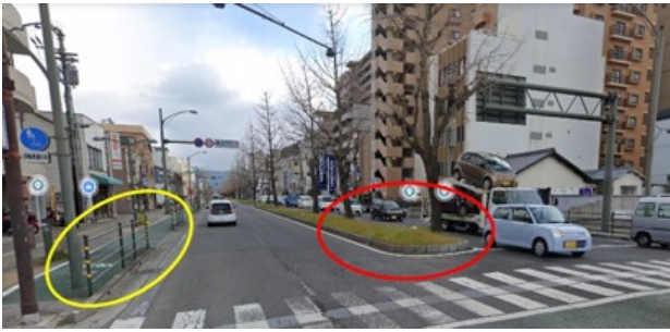
図-2 侵入不可の中央分離帯と歩道部例
