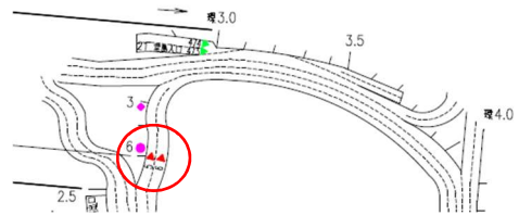
図-7 中之島 JCT 合流手前（環状線）における検知器位置
