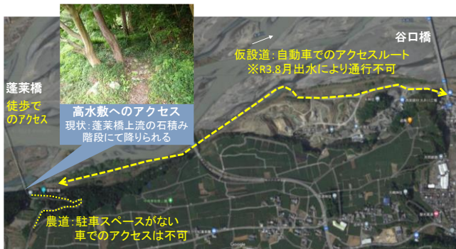
図-7 右岸側高水敷へのアクセス路
