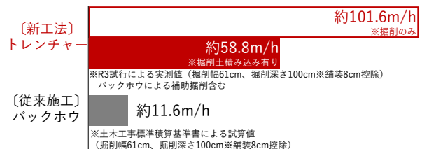
図-4 施工速度の比較 (駐車帯部)
