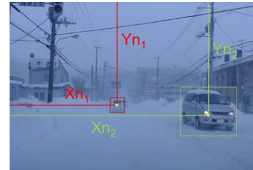
図-4 Yolov3 による周辺車両の座標の取得
