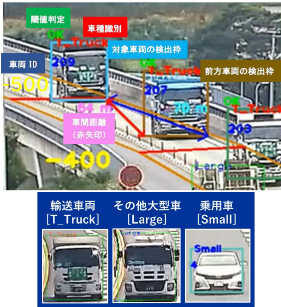
図-2 AI画像解析による車間計測例
