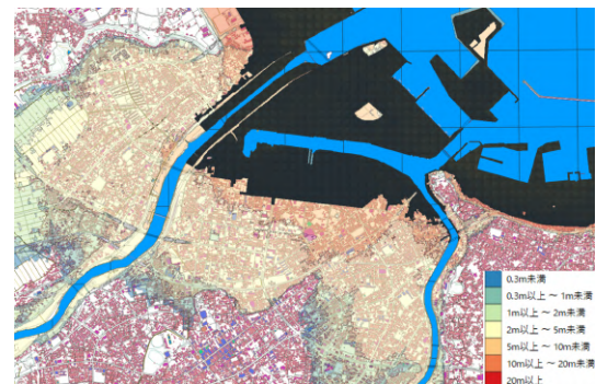
図-1 QGIS による今後想定される八戸市の浸水区域 2) (黒範囲：東日本大震災による浸水区域 3) )
