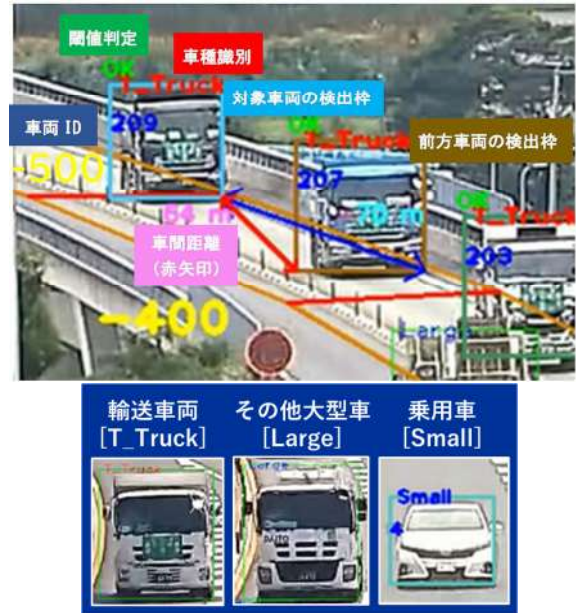
図-7-2 AI画像解析による車間計測例
