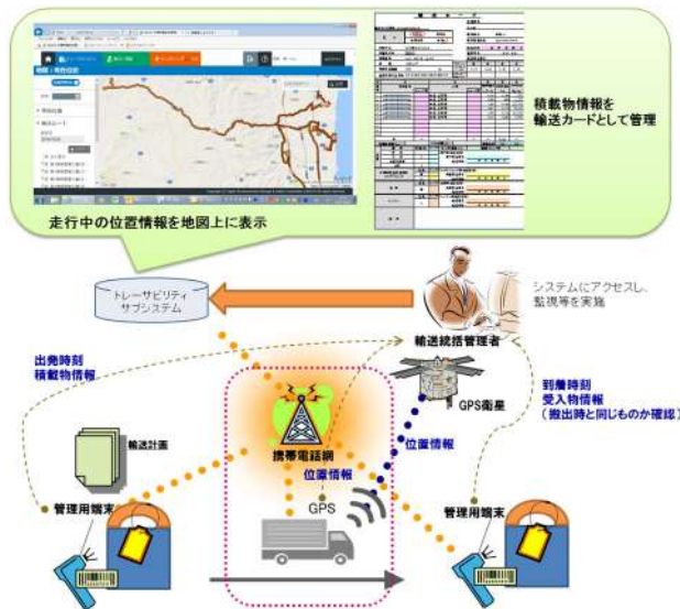
図4-1 GPS 車載器による輸送統括管理
