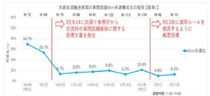
図-7-6 本線合流する輸送車両同士の車間距離推移
