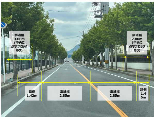
図-2 調査した道路と横断歩道の幅
