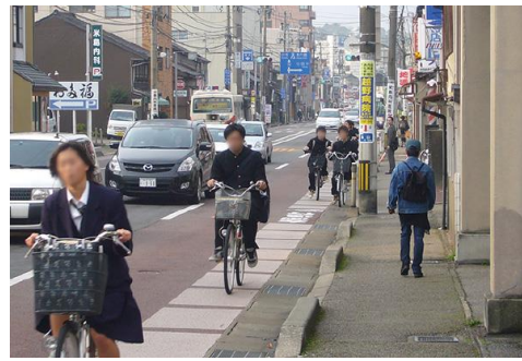
写真-1 金沢市・バス専用レーン内での自転車走行指導帯 (当時、現在は矢羽根になっている)
