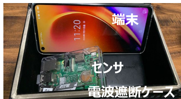
図-5 電波遮断ケースを用いた調査
