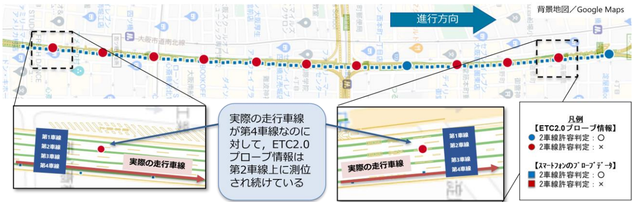
図4 スマートフォンのプローブデータと ETC2.0 プローブ情報の測位点の可視化結果 (9 周目の走行)
