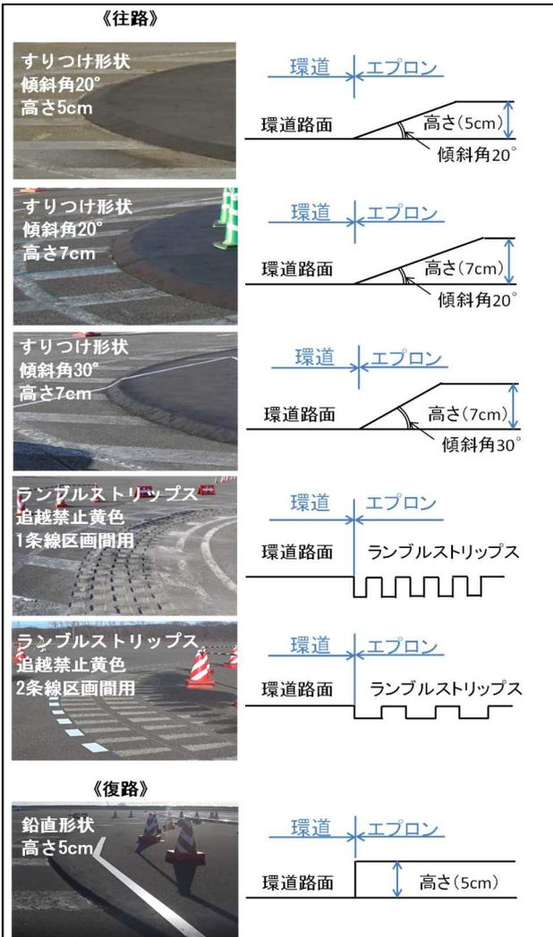
図-11 試験対象としたエプロン端部形状
