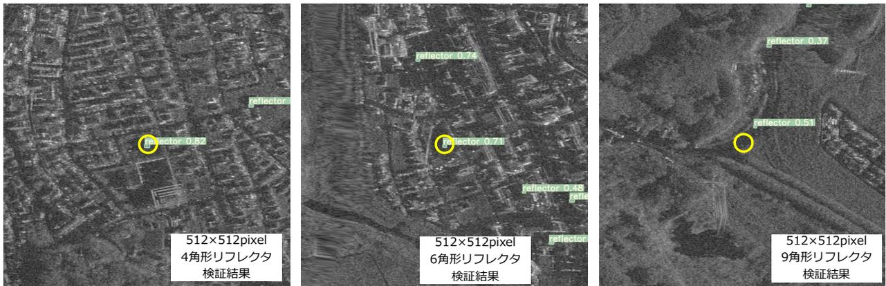
図-4 YOLOv5を用いたリフレクタの検出結果
