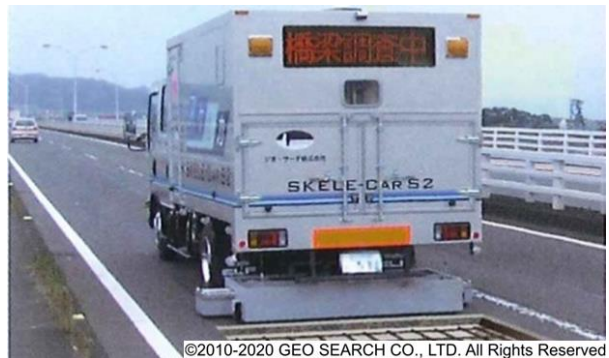
図-4 検査車両による内部劣化の調査の様子
