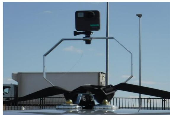
図-2 撮影機材 (GoPro Fusion) と架台
