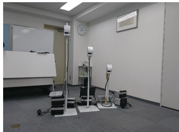
図-4 レーザーカウンターの設置高さ別の設置状況
