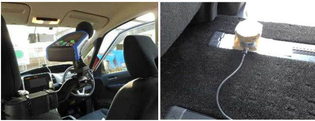
写真-4 車内騒音(左)・車内振動(右)の測定状況
