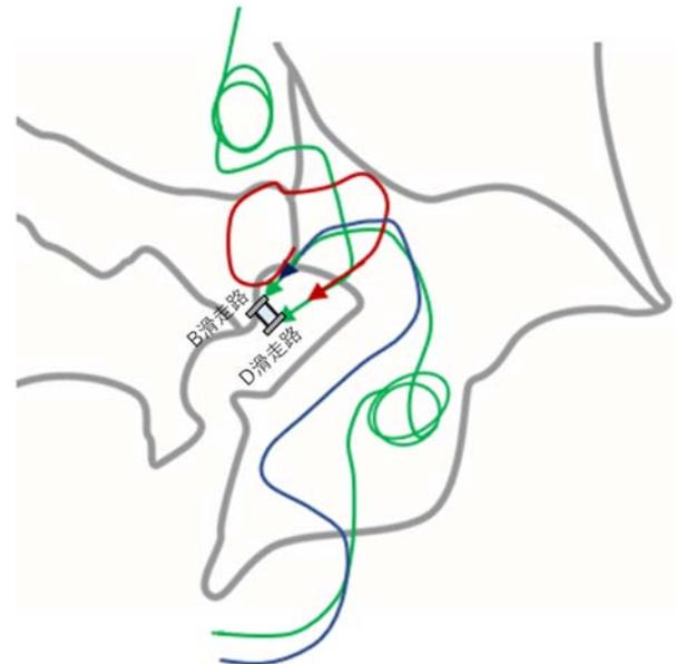
図-9 BS発生時の着陸機の挙動の例
