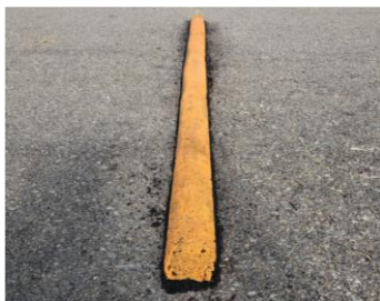
図-3 実験時使用したバンプの写真 (バンプ C1)
