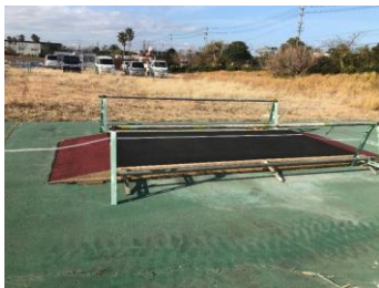
図-2 実験時使用したハンプの写真 (ハンプ B1)
