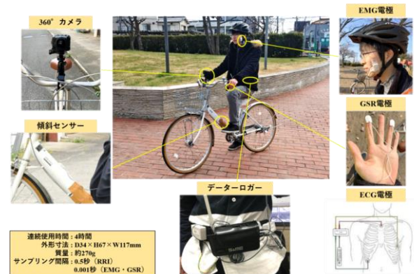
図-2 計測機器及び電極取り付け位置
